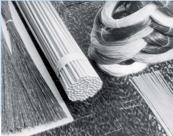
Celluloid in Platten, Stäben, Rohren und Ringen zur Herstellung verschiedener Celluloidwaren, um 1940.
